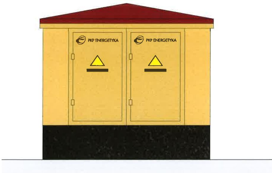
stacja transformatorowa lubelska małogabarytowa w obudowie betonowej typu STLmb-3
